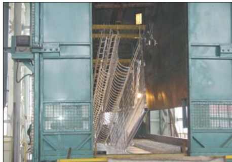
Proces cynkowania ogniowego na nowym piecu cynkowniczym
