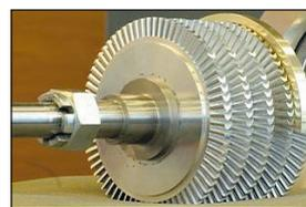
Wirnik mikroturbiny D 110mm
