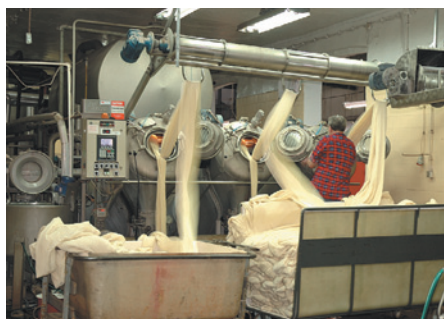
Aparat barwiarski firmy „Thies” do barwienia bardzo delikatnych dzianin i tkanin.
