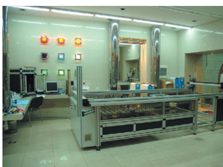
Robot laboratoryjny do sporządzania kąpieli farbiarskich firmy „Tecnorama”.
