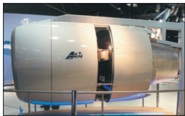
Gondola silnika CF34-8 (produkowana przez Aircelle w kooperacji z Aermacchi), do której Hispano-Suiza Polska będzie produkować części.
