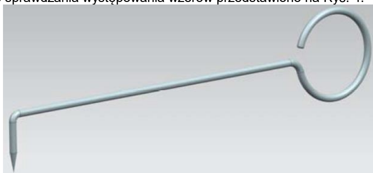
Rys. 4. Przykładowy wygląd drutu do sprawdzania występowania wżerów korozji.
