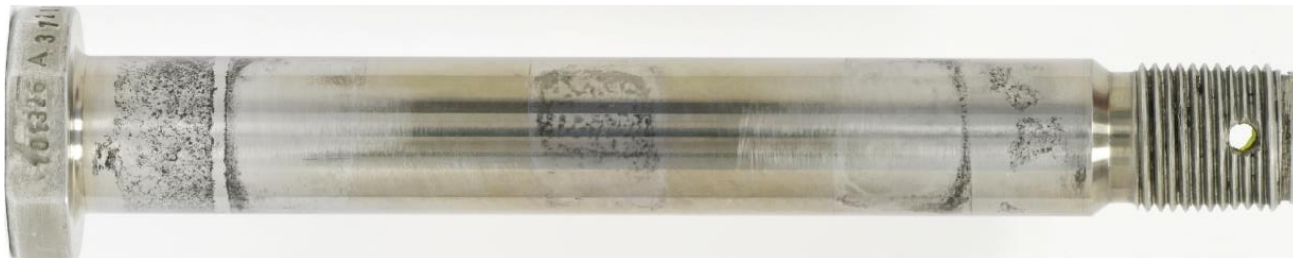
Rys. 1. Przykładowa postać korozji powierzchniowej i wżerowej.
