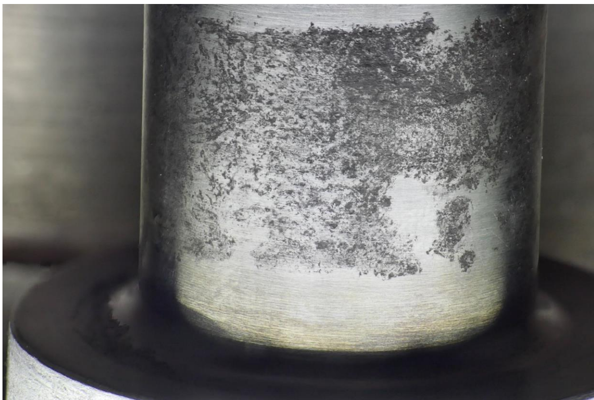
Rys. 2. Wżery korozyjne z otaczającą korozją powierzchniową w powiększeniu.
